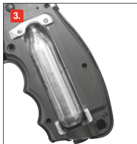
3. Inserire la capsula CO 2 come da illustrazione.
