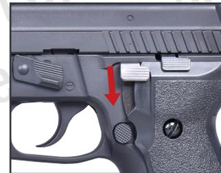
Die Waffe hat keine Sicherung. Um einen gespannten Hahn sicher zu entspannen, drücken Sie den Entspannhebel nach unten.
