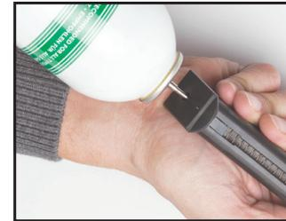
Das Ventil am Boden des Magazins dient zum Befüllen des Magazins mit Gas.
