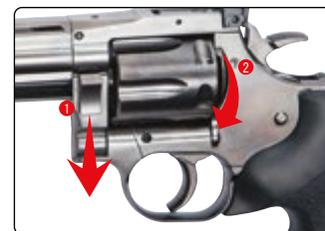
Drücken Sie mit der linken Hand die Trommel-Entriegelung nach unten und mit der rechten Hand die Trommel von hinten heraus.
