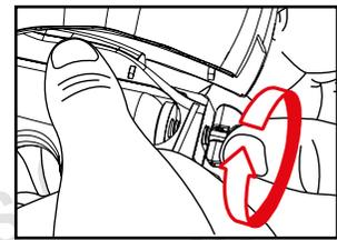
Drehen Sie die Schraube an der Unterseite des Faches zügig und im Uhrzeigersinn, um die Kapsel anzustechen. Bringen Sie die Griffabdeckung wieder an.
