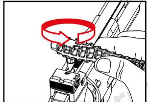
Lösen Sie die Schraube, in dem Sie sie gegen den Uhrzeigersinn drehen.
