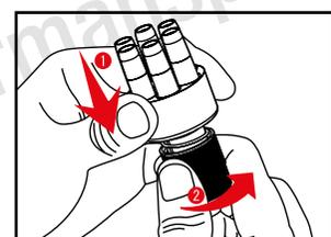
Drücken Sie den Speedloader nach unten und drehen Sie sich nach rechts, um die Hülsen zu verriegeln.
