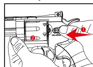
Schieben Sie die Sicherung mit dem rechten Daumen nach vorne (OPEN) und drücken Sie dann mit der linken Hand die Trommel seitlich heraus.
