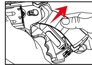
Entfernen Sie die CO<sub>2</sub>-Abdeckung am Griffstück.
