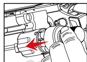
Setzen Sie den Speedloader in die Trommel und drücken Sie, bis die Hülsen in der Trommel freigesetzt werden.
