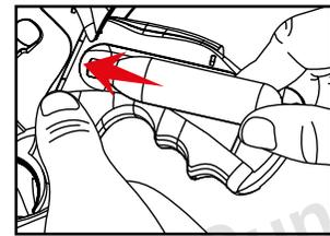
Positionieren Sie eine 12g CO<sub>2</sub>-Kapsel im CO<sub>2</sub>-Fach.
