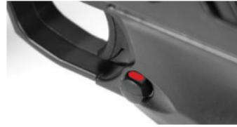
Schieben Sie die Sicherung solange, bis man die rote Markierung sieht. Die Pistole ist jetzt schussbereit.
