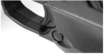
Schieben Sie die Sicherung solange, bis man die rote Markierung nicht mehr sieht. Der Abzug ist jetzt gesperrt.
